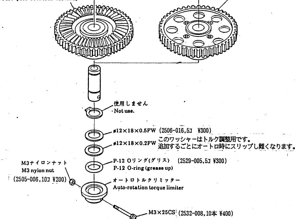
●純正又はSEメインギヤに組み込み、オートロト時のテール駆動をさせます。
